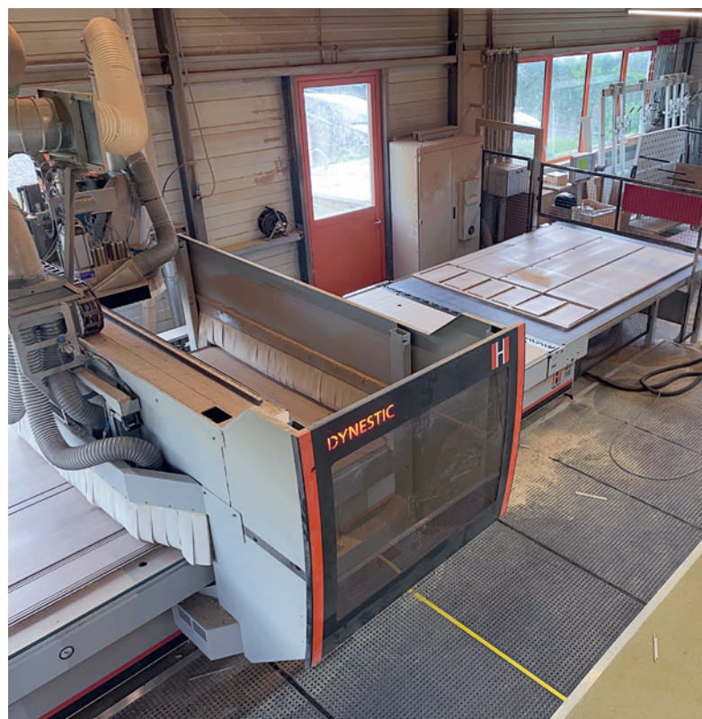
Die Schreinerei Schmutz AG in Ried bei Kerzers FR setzt auf eine Nesting-Anlage.
