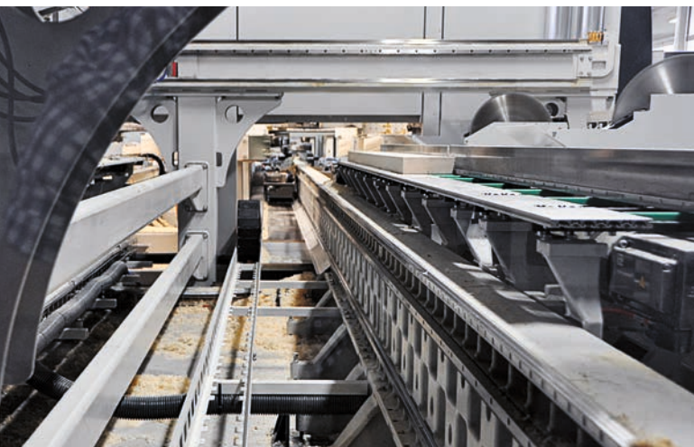
Die Teile werden von zwei Sägeblättern gekappt. Zangentische führen sie dann durch die 40 Meter lange Bearbeitungslinie.
