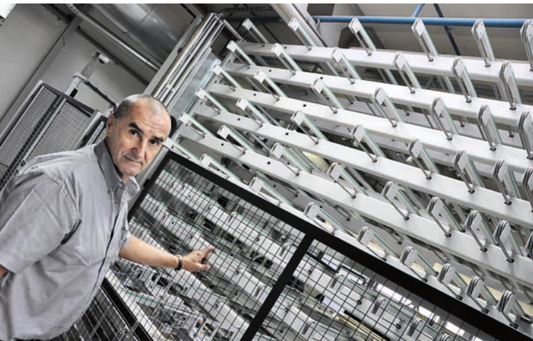
Der Materialpuffer hat Platz für 200 Teile. Von dort gelangen diese in die «Conturex».
