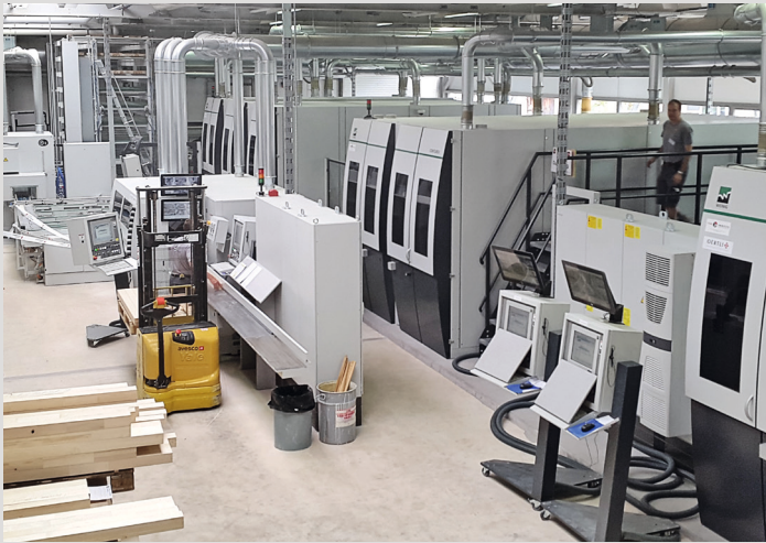
Teil der neuen Produktionsanlage bei der von Euw Fenster AG. Grösse: 40 x 15 m Gewicht: 120 t Leistung: 2 Teile/min
